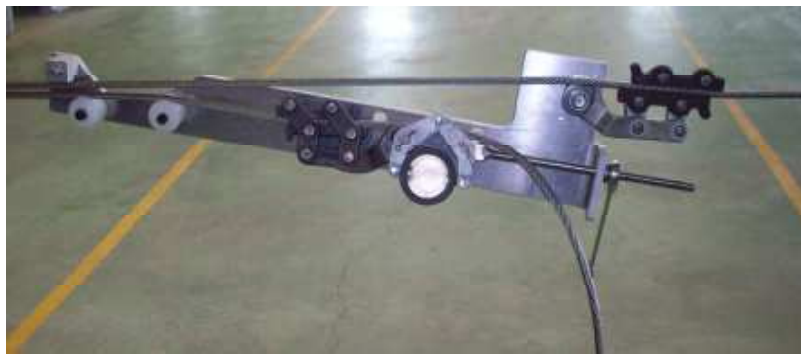
Y-Seilspannvorrichtung zum Spannen von Oberleitungen für Hochgeschwindigkeitszüge
